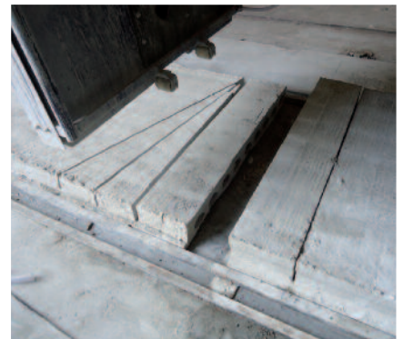
Máquina de Corte Angular MCA 500, para cortar painéis e lajes protendidas, que atenderá projetos personalizados e complexos
